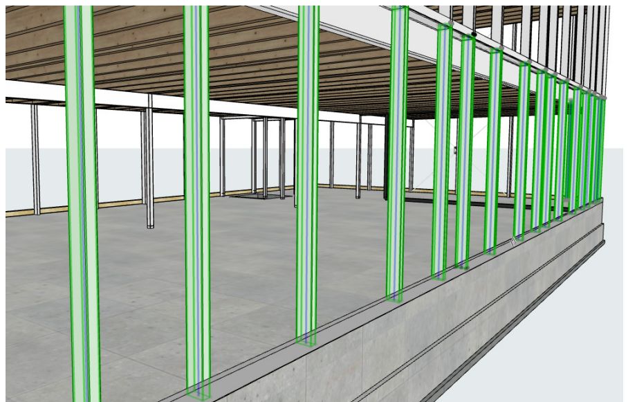
16. ÁBRA: Acél előregyártott pillérek pontos pozicionálása AR technológia segítségével (forrás: SzZs)
