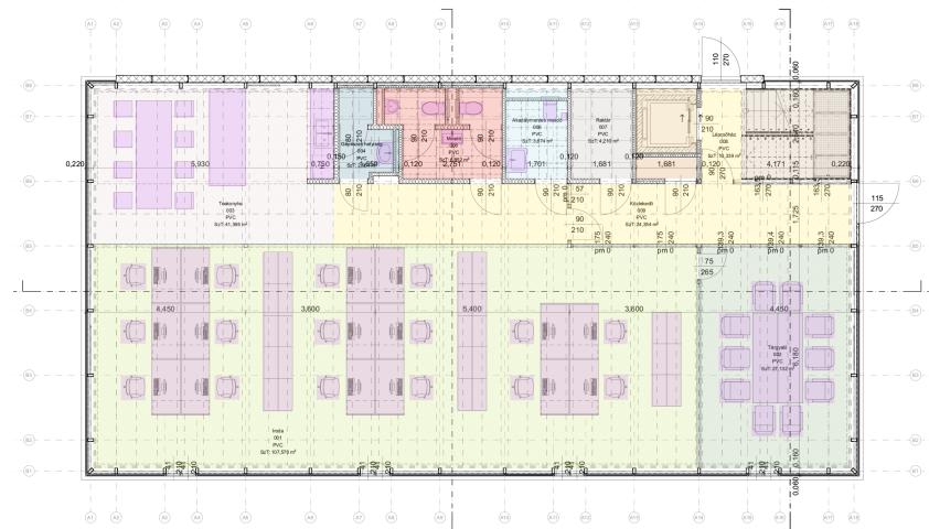
12. ÁBRA: Generatív tervezés: a földszint helyiség- és bútoroptimalizált kialakítása [forrás: SzZs]
